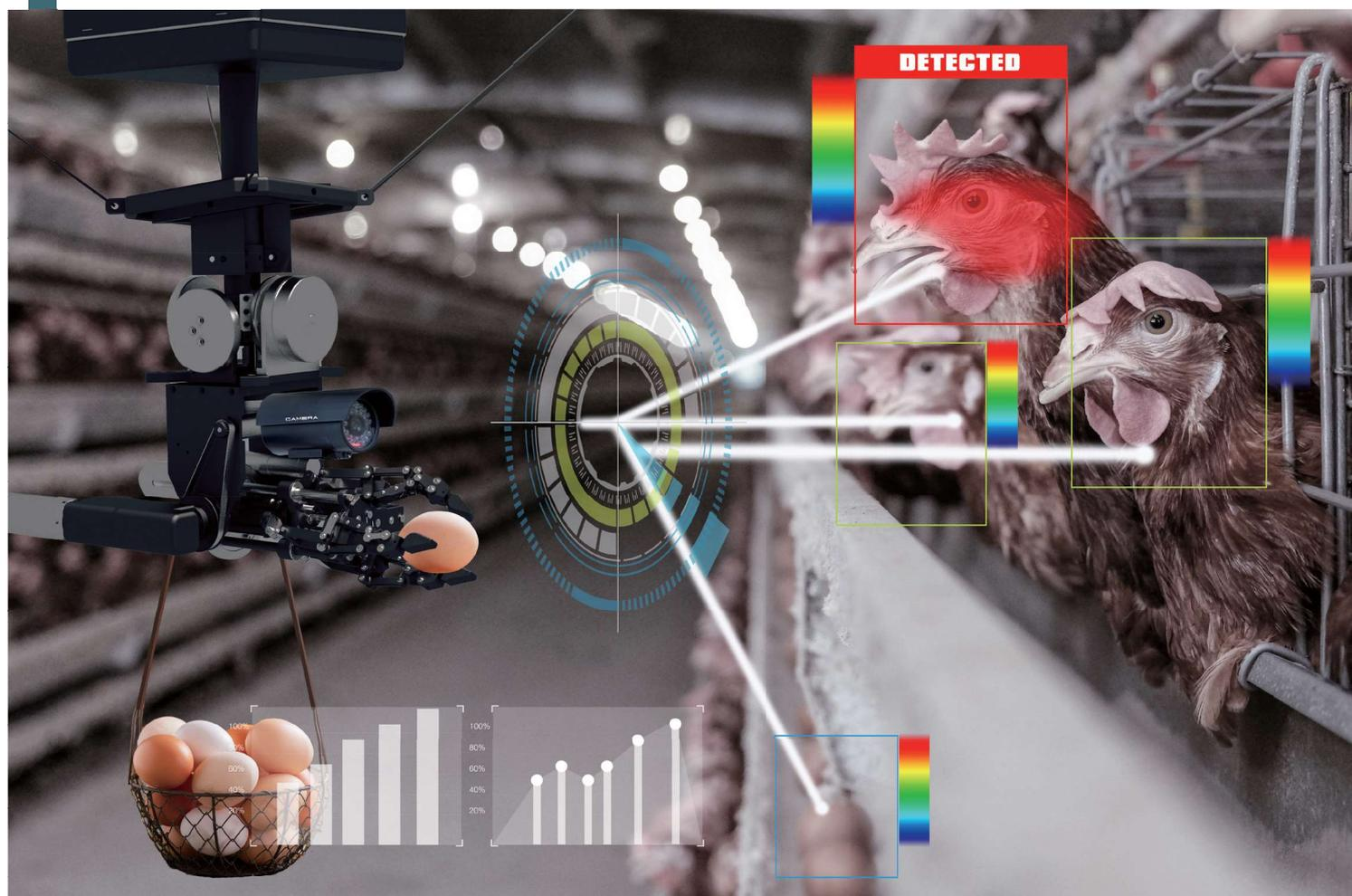
養鶏場で家畜の異常をいち早く感知、AI解析し鳥インフルエンザなどに早期対応するシステム。24時間監視して遠隔地へデータ通信ができ、家畜を刺激しない静音性で卵の収穫も同時に行え、業務の大幅な効率化が可能になります。
